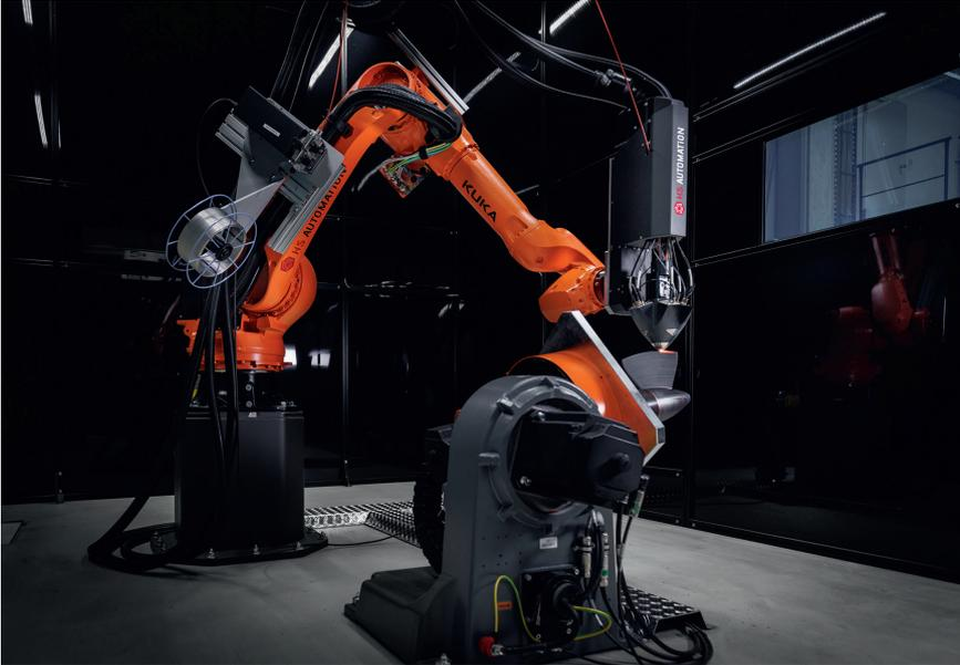
4 Das Laserauftragsschweißen verringert den Materialaufwand im Vergleich zum Fräsen oder Drehen aus einem kompletten Metallblock um bis zu 98 Prozent © Kuka
