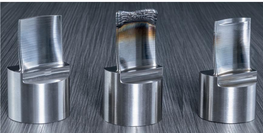
Smart reparieren in drei Stufen mit HyperMill: vorbereitetes Turbinenschaufelblatt, Blatt mit Materialauftrag und fertiges Blatt nach additiver und subtraktiver Bearbeitung (von links nach rechts) © Open Mind
